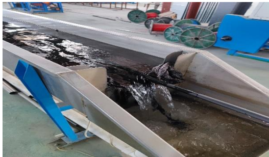
循环冷却装置
